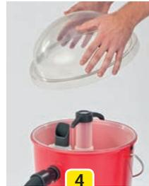
... und das Gerät mit der Klarsichtkuppel verschlossen. Gerät anschalten. Beide Kippschalter auf „ON“.
