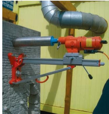
So wird zum Bsp. beim Bohren in Beton grundsätzlich mit einem Dübel-befestigten Bohrständer gearbeitet.
