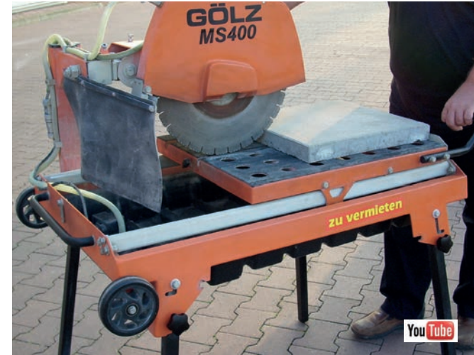
Nass-Schneidemaschine bis 50 cm Schnittlänge
