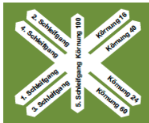
Schleiffolge bei alten, stark verschmutzten Dielen
